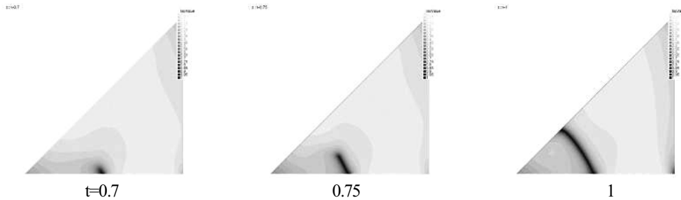
Fig.2 フェーズフィールドの分布の時間発展。黒い領域がき裂部分を表現している。
