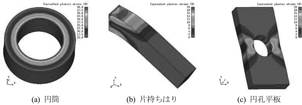
図3) 解析結果の変形と相当塑性ひずみ分布
