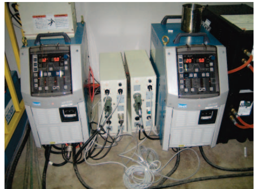
プラズマ MIG 溶接システム（上）、および MIG アークとプラズマの両電源（下）
