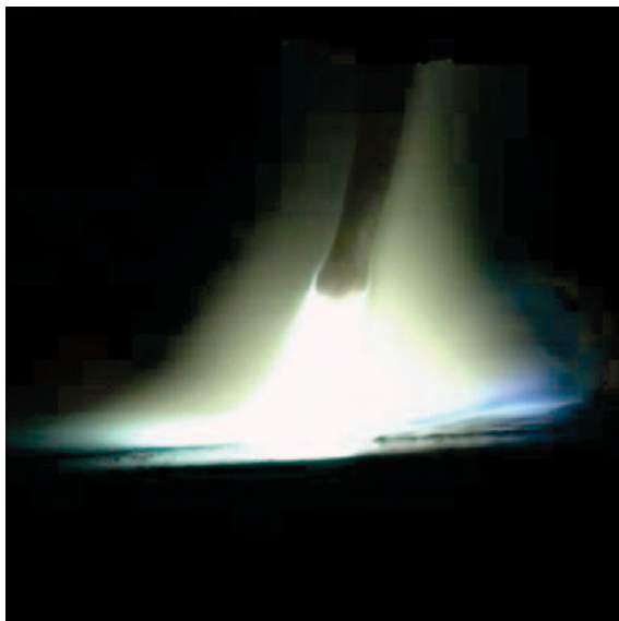
プラズマ化したシールドガスに覆われる溶接ワイヤおよび溶滴
