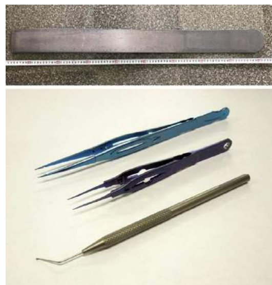
図 2.チタン圧延材と医療器具の試作品
