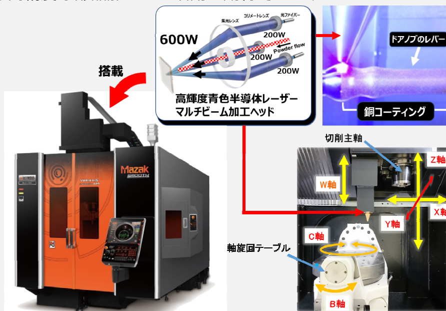
図1 高輝度青色半導体レーザーマルチビーム加工ヘッドを搭載したハイブリッド複合加工機
